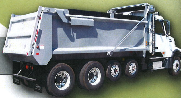
Rampe tubulaire inclinée éliminant l'accumulation de matériaux
