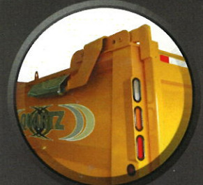
Ouverture porte surélevée & (3) lumières
